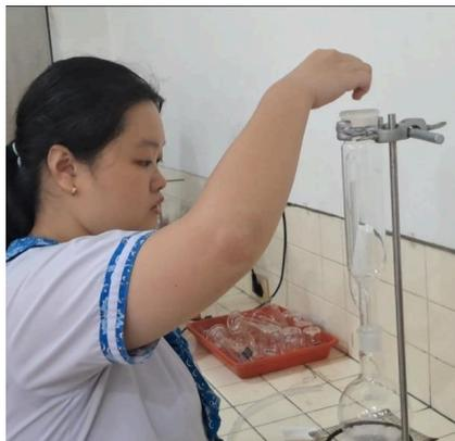
Sampel yang dibungkus kertas saring dimasukkan ke dalam alat *soxhlet*
