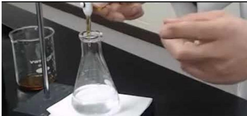
**Gambar 2.6** Titrasi Iodimetri
