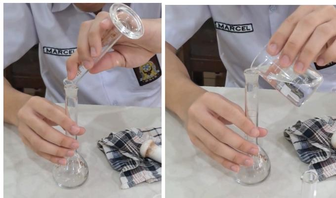
Memasukkan 1 ml *kalium iodida* 0,1 M dan 100 ml *aquades* ke dalam labu ukur
