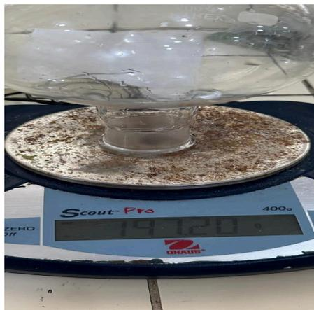
Massa labu *soxhlet* setelah pengujian
