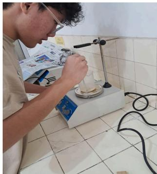
Mengurangi kadar air dengan diuapkan menggunakan *magnetic stirrer*
